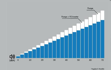
Die Lautstärke der Pumpe kann mithilfe des VS Inverter X um bis zu 25% reduziert werden.
