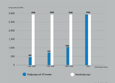
Mithilfe des VS Inverter X kann die Pumpgeschwindigkeit an die verschiedenen Pumpvorgänge angepasst werden. Die Betriebskosten werden somit um bis zu 80% reduziert.
