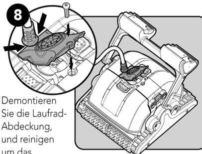
Demontieren Sie die Laufrad-Abdeckung, und reinigen um das Laufradgehäuse, dann bauen Sie es wieder zusammen.
