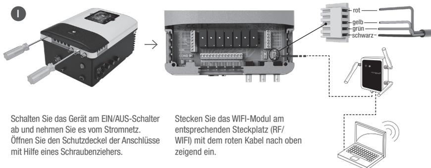
Schalten Sie das Gerät am EIN/AUS-Schalter ab und nehmen Sie es vom Stromnetz. Öffnen Sie den Schutzdeckel der Anschlüsse mit Hilfe eines Schraubenziehers.
