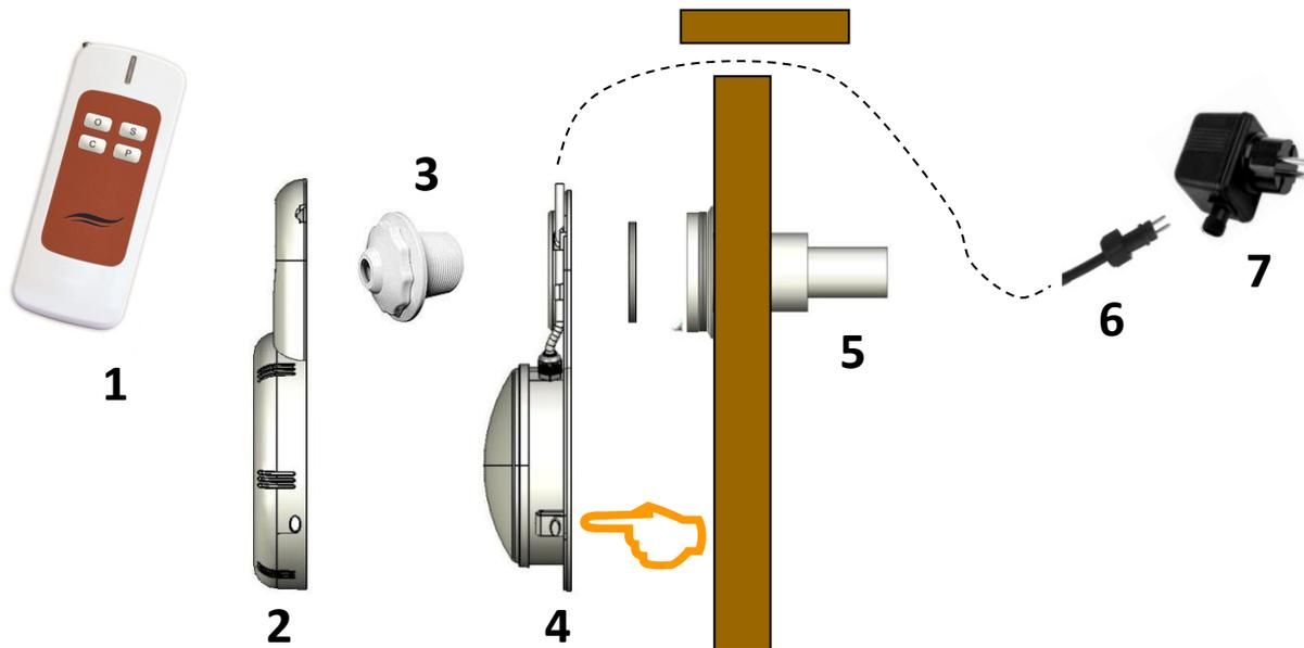
Achtung : Die Entfernung zwischen Schwimmbecken und Transformator muss bei Nutzung min. 3,5 m betragen
