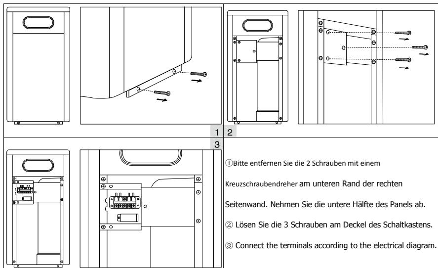
( Hinweis: Bitte öffnen Sie die Rückseite für den Stromanschluss. Die Bedienung ist gleich wie oben. )
