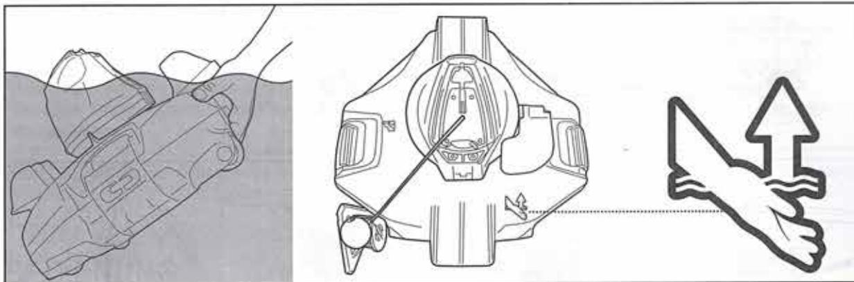
5. Schieben Sie den Schalter auf OFF. Spülen Sie den Poolroboter nach jedem Einsatz mit sauberem Wasser ab. Verwenden Sie dazu KEINE Reinigungsmittel.
